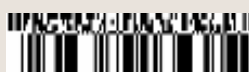
O GS1 DataBar Composite combina elementos 1D e 2D em um único símbolo de código de barras
